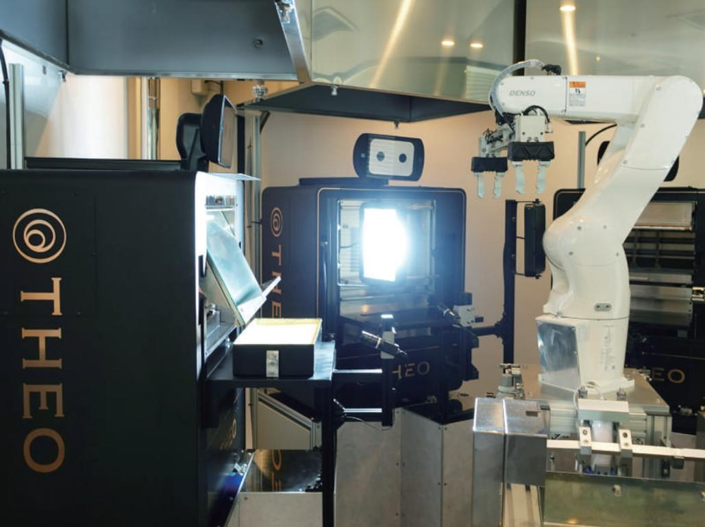
バウムハウスの無人工房は3台のTHEO(オープン)と1台のロボット、コンベアで構成される
